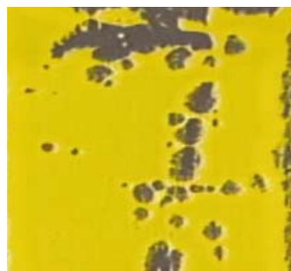
Плохое смачивание поверхности формы из-за высокого коэффициента поверхностного натяжения гелькоута
